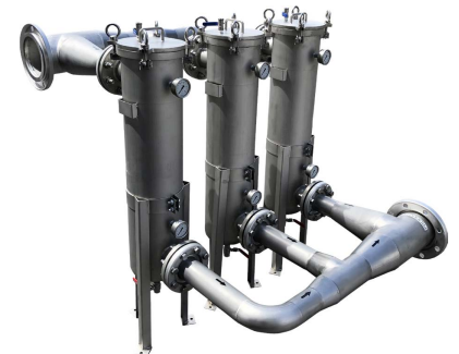
Rinnakkaisasennusmahdollisuus, jossa tulovirrat kuristettu samanlaisiksi.
